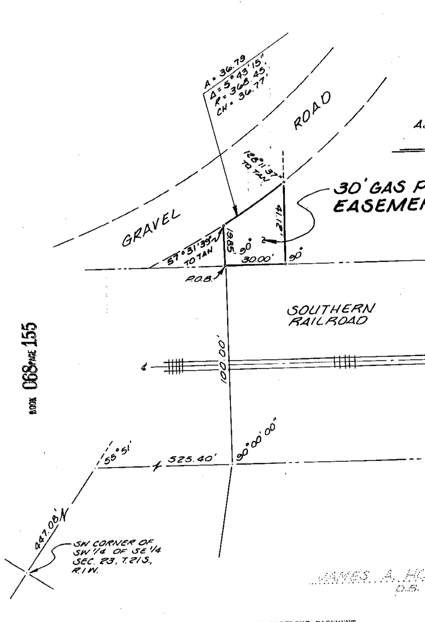
30' PERMANENT GAS PIPELINE EASEMENT
